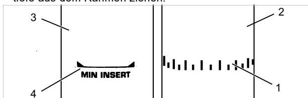
Abbildung 19: Detailansicht Sattelstützen, Beispiele für die Markierung der Mindesteinstecktiefe
