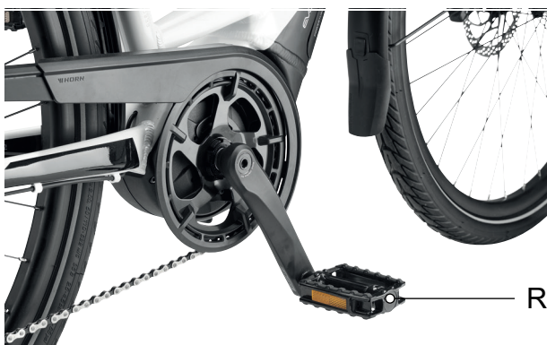
Abbildung 14: R Pedal im rechten Kurbelarm
