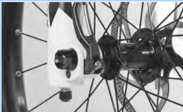
Illustration 139 : Régler la force de serrage de l'attache rapide
