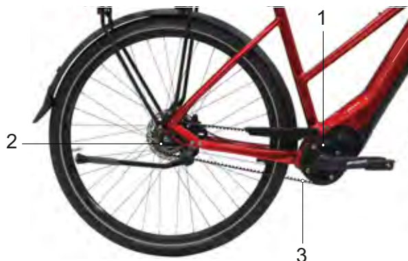
Illustration 28 : Schéma de l'entraînement à courroie
