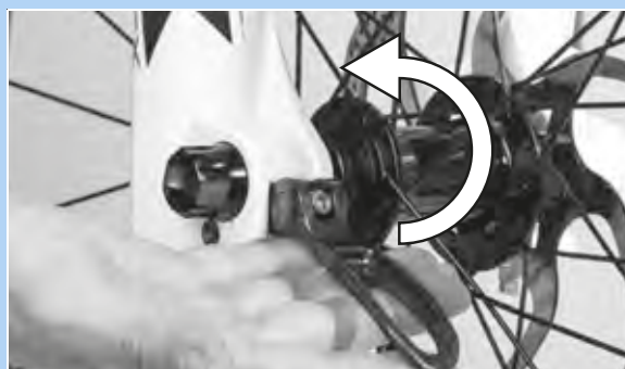
Illustration 58 : Enfoncez le levier d'attache rapide dans le sens de la flèche
