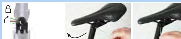
Illustration 179 : Fermer le réglage de la hauteur
