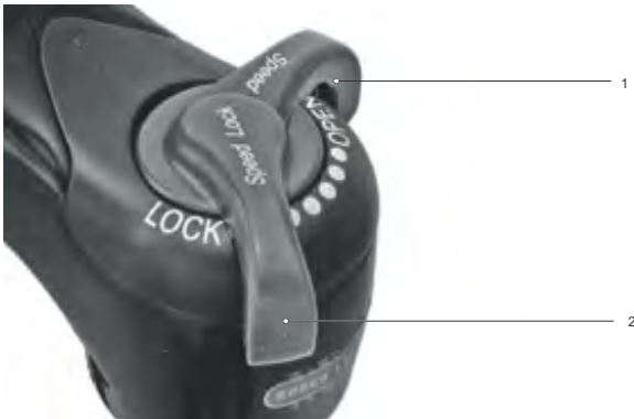
Illustration 211 : Régler le dispositif de réglage de la compression sur un niveau plus souple
