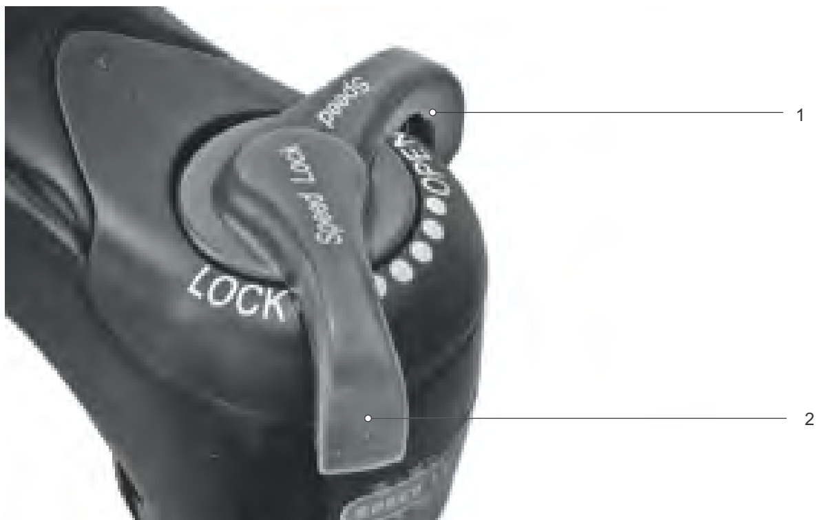
Illustration 121 : Amortisseur de compression Suntour en position ouverte (1) et fermée (2)
