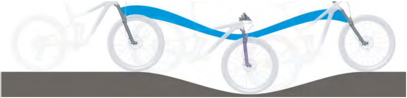
Illustration 208 : Suspension trop souple de la fourche suspendue dans les côtes
