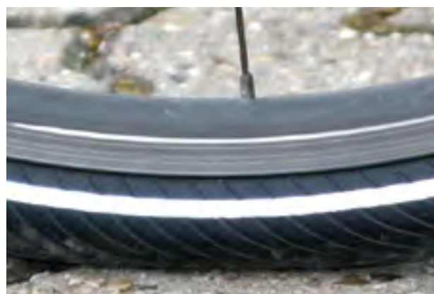
Illustration 92 : Pression correcte. Le pneu se déforme à peine sous le poids du corps
