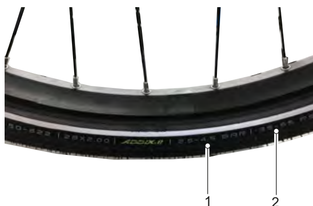
Illustration 128 : Pression des pneus en bar (1) et psi (2)
