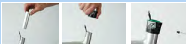
Illustration 166 : Monter la douille de glissement et l'enveloppe extérieure
