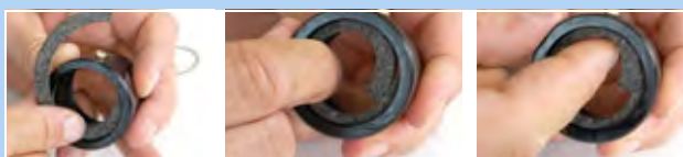
Illustration 190 : Insérer l'anneau de feutre
