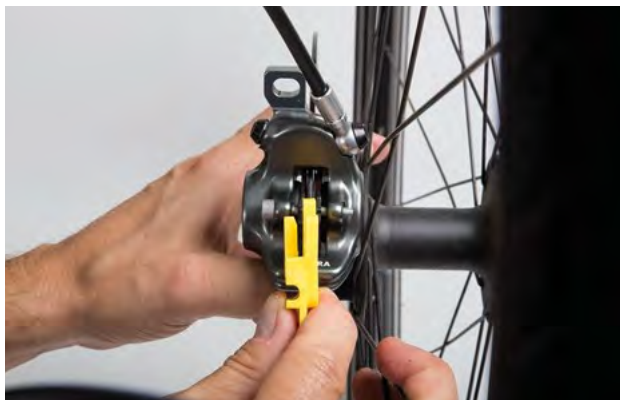
Illustration 131 : Contrôler la plaquette de frein montée à l'aide de la cale de transport
