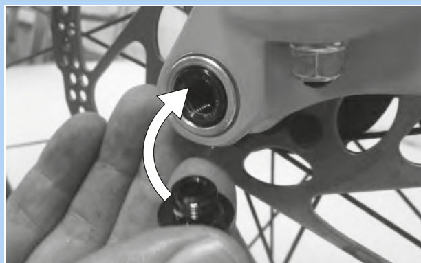
Illustration 53 : Enfoncez le levier d'attache rapide dans l'axe
