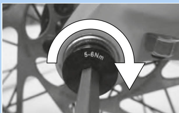
Illustration 54 : Serrer la vis de blocage
