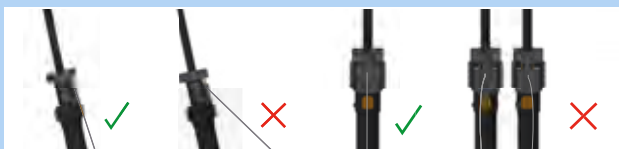
Illustration 169 : Câble Bowden correct et incorrect
