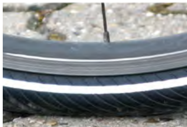
Illustration 86 : Pression correcte. Le pneu se déforme à peine sous le poids du corps
