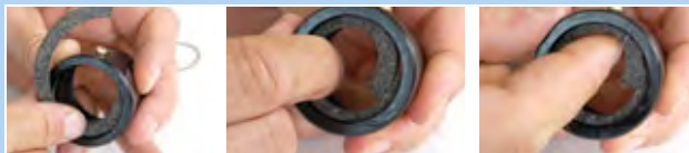
Illustration 155 : Insérer l'anneau de feutre
