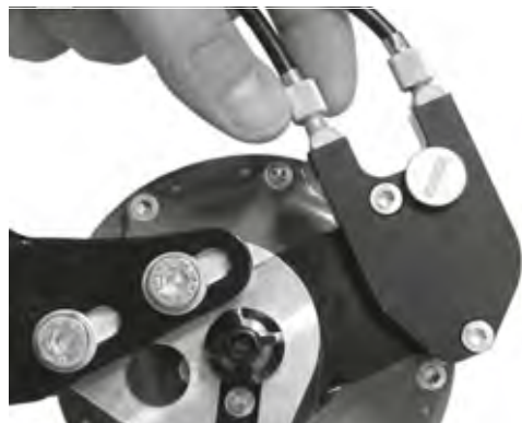
Illustration 135 : Sur les versions de moyeux ROHLOFF avec commande externe du changement de vitesse, le dispositif de réglage de la tension est situé sur le boîtier de câbles qui est placé sur le côté gauche.
