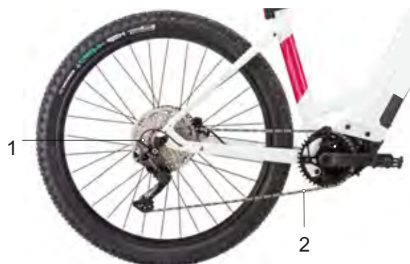
Illustration 27 : Schéma de l'entraînement à chaîne avec dérailleur
