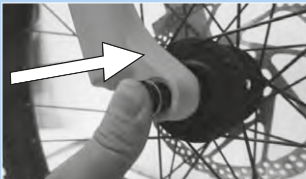
Illustration 51 : Enfoncez l'axe dans le sens de la flèche
