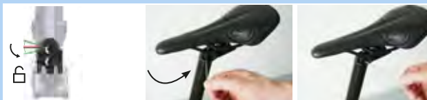
Illustration 142 : Placer le mécanisme de réglage de la hauteur en « position ouverte »
