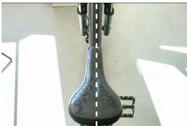
Illustration 69 : Orienter la selle dans le sens de la marche
