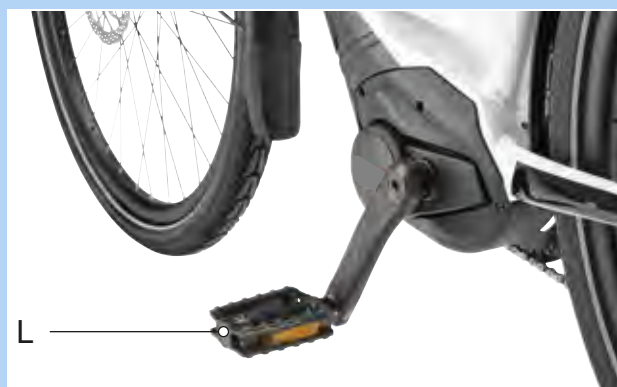
Illustration 66 : Pédale L dans le bras de manivelle gauche
