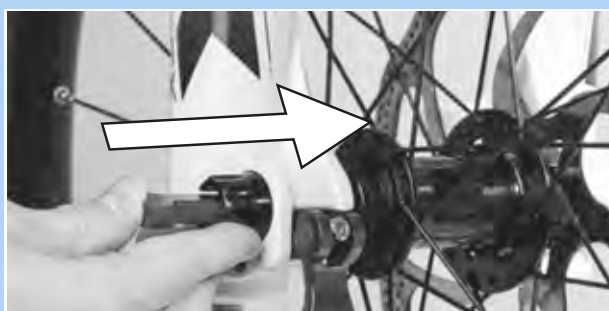
Illustration 57 : Enfoncez le levier dans le sens de la flèche
