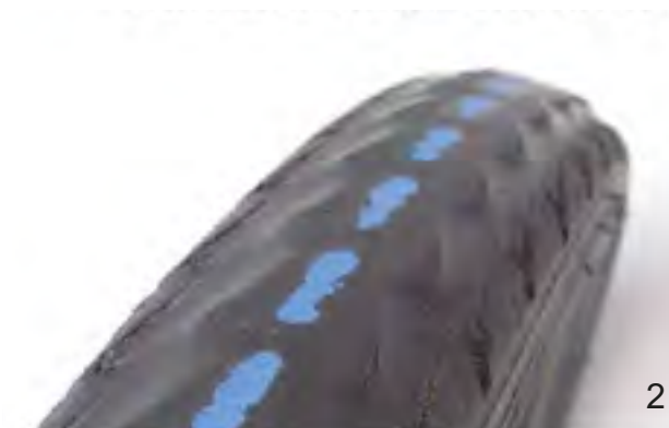
Illustration 129 : Pneu sans profil pouvant encore être utilisé (1) et pneu avec bande de protection visible (2) devant être changé
