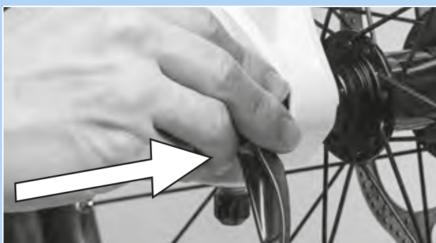
Illustration 62 : Enfoncez l'attache rapide dans le sens de la flèche
