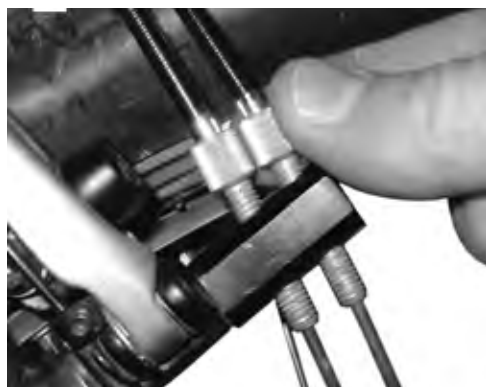
Illustration 134 : Sur les versions de moyeux ROHLOFF avec commande interne du changement de vitesse, le dispositif de réglage de la tension est situé sur le contre-support de tension.
