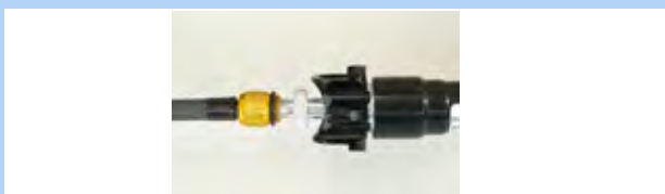
Illustration 160 : Pomper de l'air dans la cartouche
