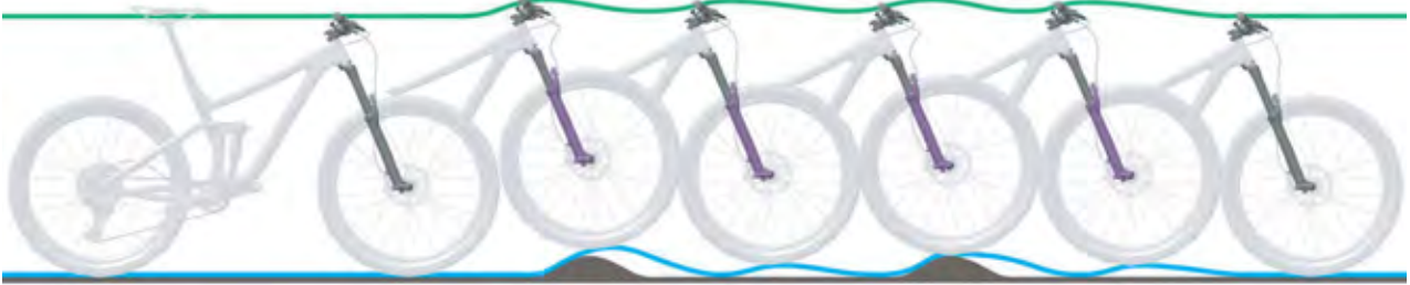
Illustration 204 : Détente trop rapide de la fourche suspendue
