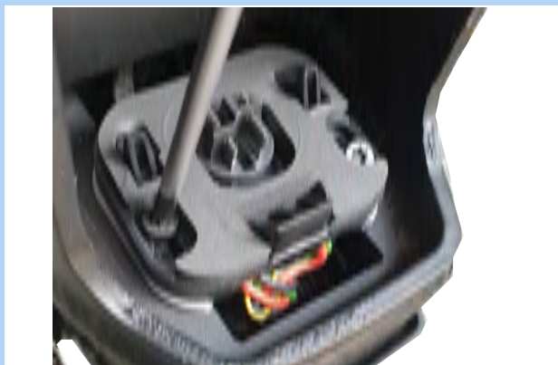
Illustration 46 : Desserrez les vis du logement de batterie
