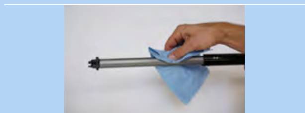
Illustration 195 : Nettoyer la rainure de guidage longitudinale
