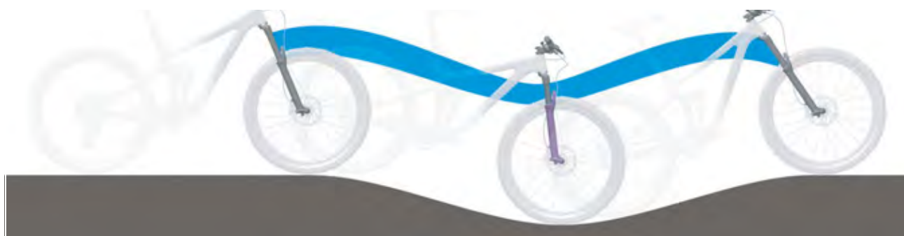
Illustration 9 : Comportement optimal de la fourche en terrain vallonné
