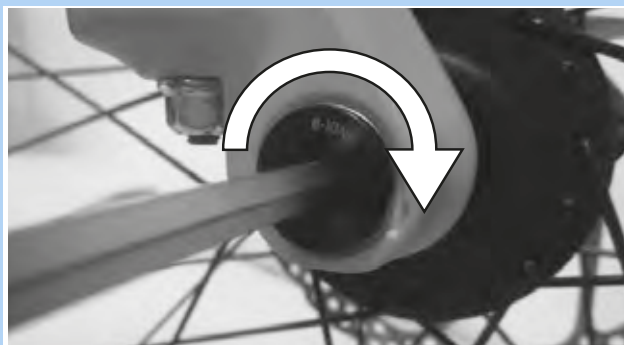
Illustration 52 : Serrer l'axe dans le sens de la flèche
