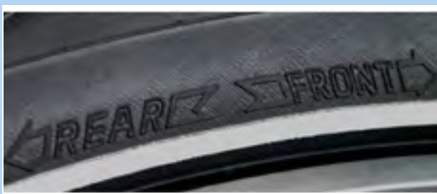
Illustration 50 : Flèche directionnelle sur les pneus VTT
