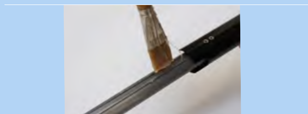
Illustration 196 : Appliquer de la graisse
