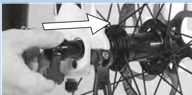
Illustration 55 : Enfoncez l'axe transversal dans le sens de la flèche
