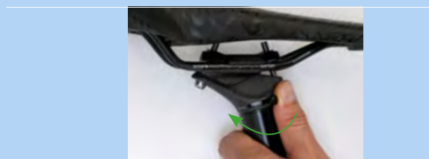
Illustration 198 : Fermer le réglage de la hauteur
