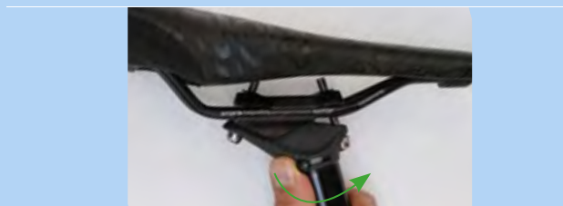
Illustration 193 : Ouvrir le réglage de la hauteur
