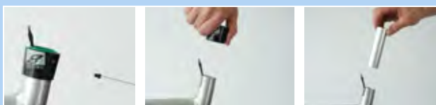
Illustration 150 : Démonter l'enveloppe extérieure et la douille de glissement
